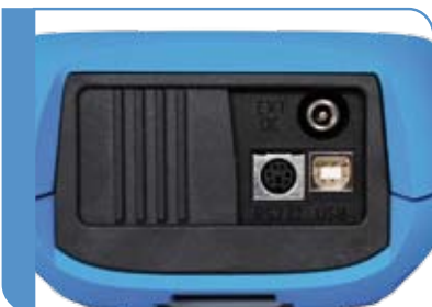
Kommunikation über USB und RS232 Schnittstelle.
