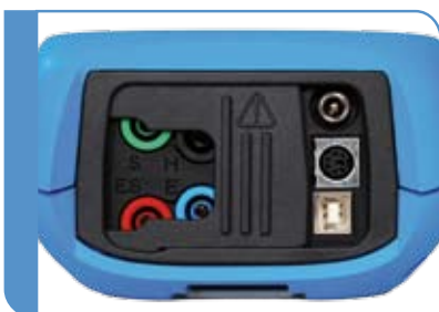
Kommunikation über USB- und RS232-Schnittstelle.
